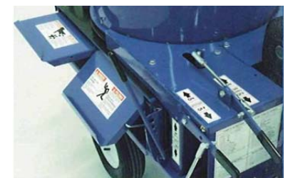
2台の排出ロドアにより資材の排出角度を調節可能です
