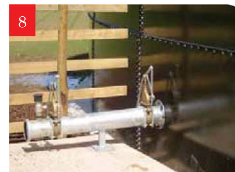
8 6"/8"ダブルスライスキットを使用してスラリータンクを空にする
