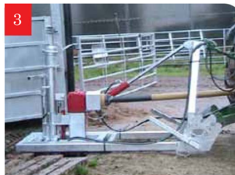
3 PTO ポンプを使用してレセプションピット(一時貯蔵槽)を空にし、スラリータンクに移送する
