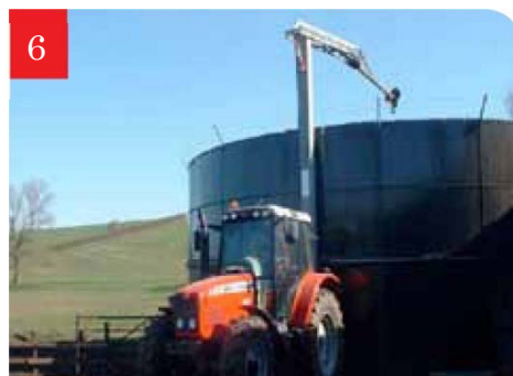
6 タンクマスターミキサーを使用してスラリー表面の塊を砕く
