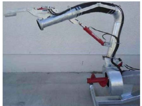
ケースにより補強されたシャフトスリーブにはポリウレタンベアリングハウジングが搭載されており、スラリーが潤滑油代わりとなることで保守作業を最小限に低減
